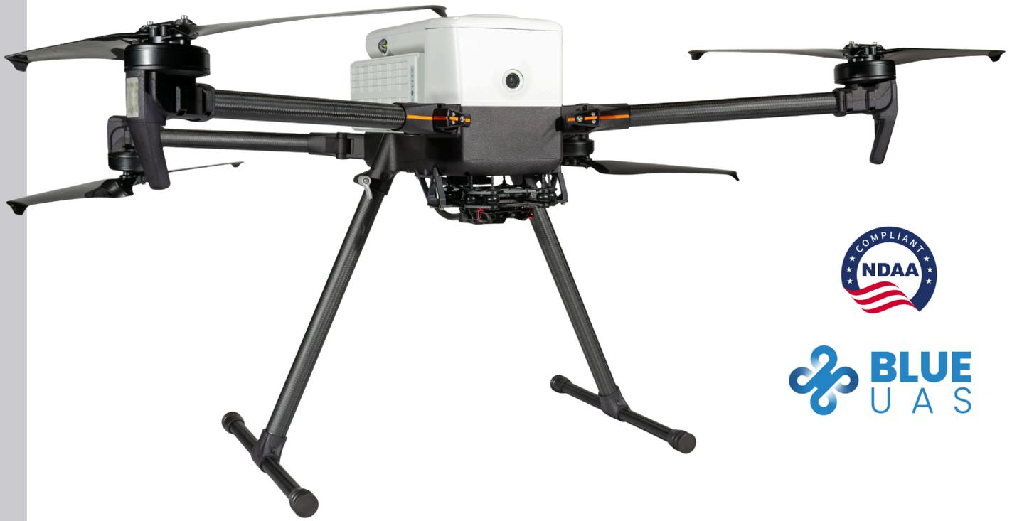
IF800 TOMCATは、軽量かつコンパクトな折りたたみ式フレームを採用し、容易な輸送と多様な環境での展開を実現します。バッテリーと付属品を収納できる専用ケースは、輸送時の利便性と保護に優れています。インフラ点検、地形マッピング、LiDAR調査といった最先端の技術を活用するユーザーにとって、高度な要求に応える機体です。さらに、BLUE UASを取得しているため、セキュリティ面でも高い信頼性を誇ります。
